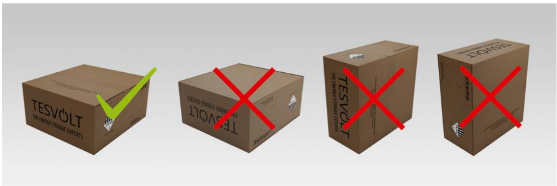
Obrázek 3.1 Povolené a nepovolené polohy pro skladování zabaleného bateriového modulu
